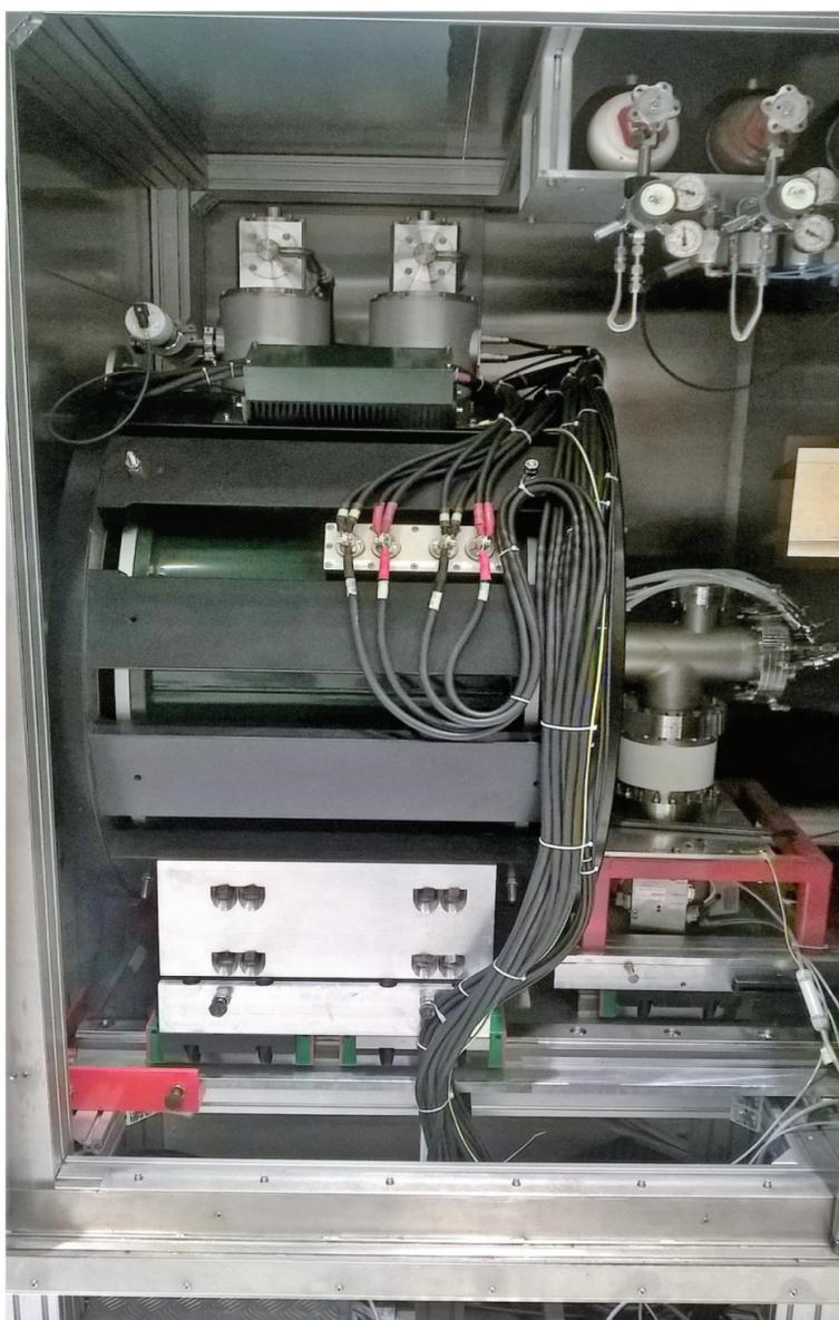
Il corpo sorgente di AISHa: il sistema magnetico superconduttivo insieme con il relativo criostato (in verde), i crioliquefattori (in alto) e gli adduttori di corrente. Al centro del criostato (sulla destra) è possibile vedere la camera cilindrica in acciaio inossidabile dentro la quale viene formato un plasma tramite l'uso di microonde ad alta frequenza e potenza. Successivamente la componente ionica del plasma viene estratta dalla sorgente tramite l'uso di un campo elettrostatico.
